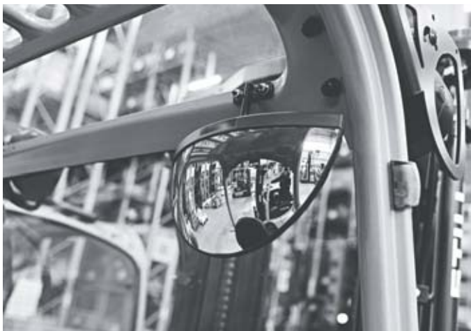
Rétroviseur panoramique pour une visibilité optimale même à l'arrière
